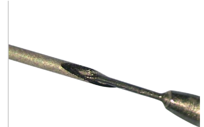
Thin Smart Needle w porównaniu z igłą insulinową (zdjęcie z mikroskopu, powiększone 32x)
